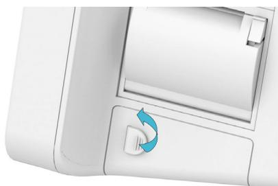
3. Поверните защитный механизм в сторону.
