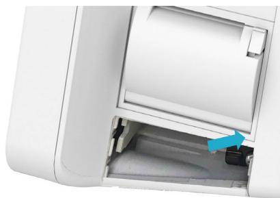
4. Вставьте аккумулятор в отсек таким образом, чтобы контакты были направлены вниз.
