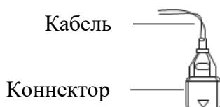
Не прикладывайте чрезмерной силы при подключении и отключении датчика, не допускайте неестественных изгибов проводов при хранении, транспортировке и использовании.
