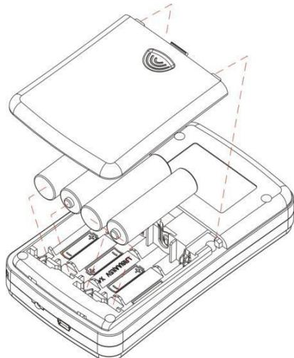
Прибор работает от четырех стандартных щелочных батареек типа «АА» или от Ni-MH аккумуляторов.
