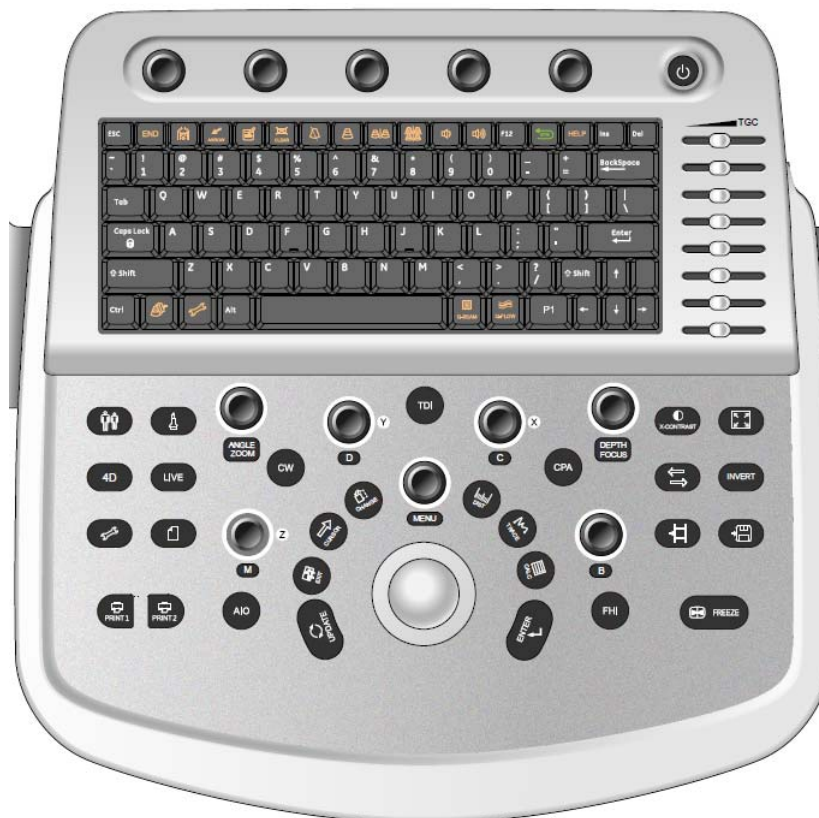
Fig. 3-5: обзор панели управления буквенно-цифровой клавиатуры
