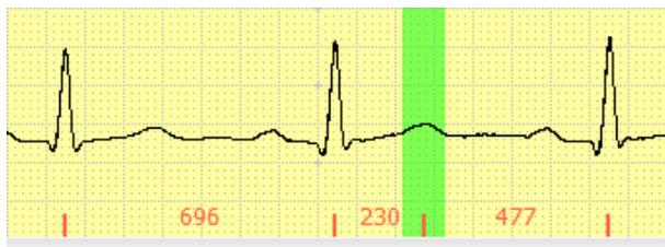
Рис. 3.11. Удаление маркеров QRS-комплексов.
